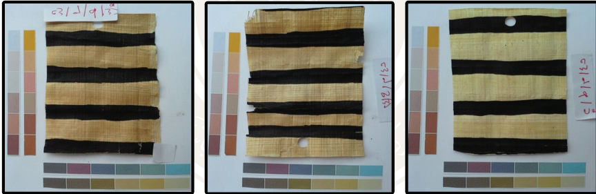
لوحة رقم (٣) التغيير اللوني لورق البردي المحبر بحبر العنص الحديدي قبل التقادم (١) وبعد التقادم الحراري (٢) والطبيعي (٣) بترتيب العينات
