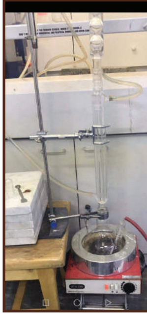
صورة توضح جهاز تحضير مادة الـ (MMMK)
