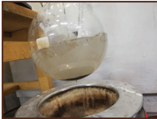
صورة توضح انتهاء تفاعل مادة (MMMK) وترسب مادة المغنسيوم غير الذائبة
